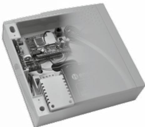
Los transmisores de EBS se ofrecen de forma independiente o en conjuntos con caja de plástico, adaptador de CA y la batería.
