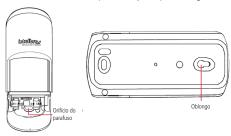
Passo 2.1: caso a instalação seja feita no canto da parede. Utilize os furos indicados na tampa traseira.
