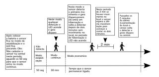
Com o jumper JP2 aberto o sensor funcionará no modo CONT (Continuo inteligente), operando da seguinte forma: Após a alimentação o sensor funcionará de maneira continua por 30 minutos para que o instalador consiga fazer todos os ajustes do sensor.
